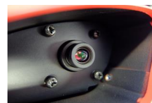
RoboVision2s カメラ部 (レンズ・光学フィルタ改良)
