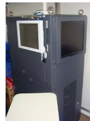
位置認識装置 (GPS+IMU+ 車輪パルス)
