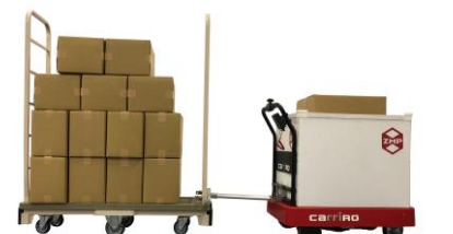
使用例：六輪台車(スリムカート)の牽引
