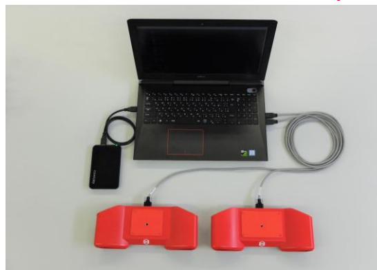
車両前後の計測にも活用可能 RoboVision2s(2 個), セット用 PC, SSD(2TB)接続時
