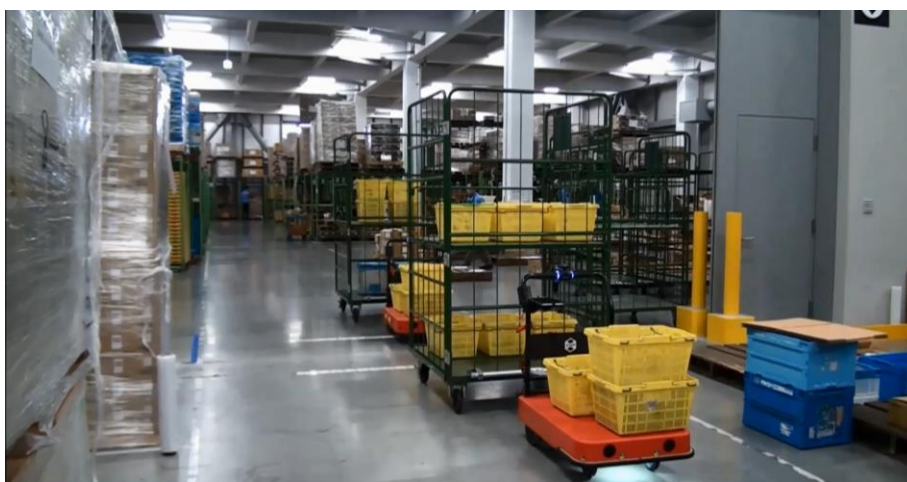
自律移動モードでカゴテナーを牽引し、更に追従モードで後続している様子
