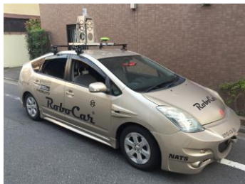
写真 3 : 走行データ取得ソリューション RoboTest®
