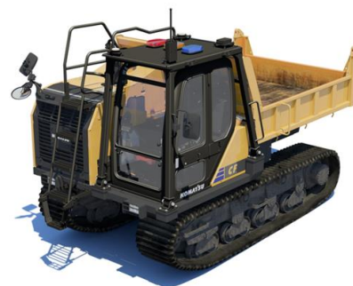
不整地運搬車「CF-1」無人自動運転モデル
