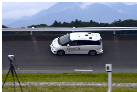
自動運転によるテストコースでのタイヤ試験
