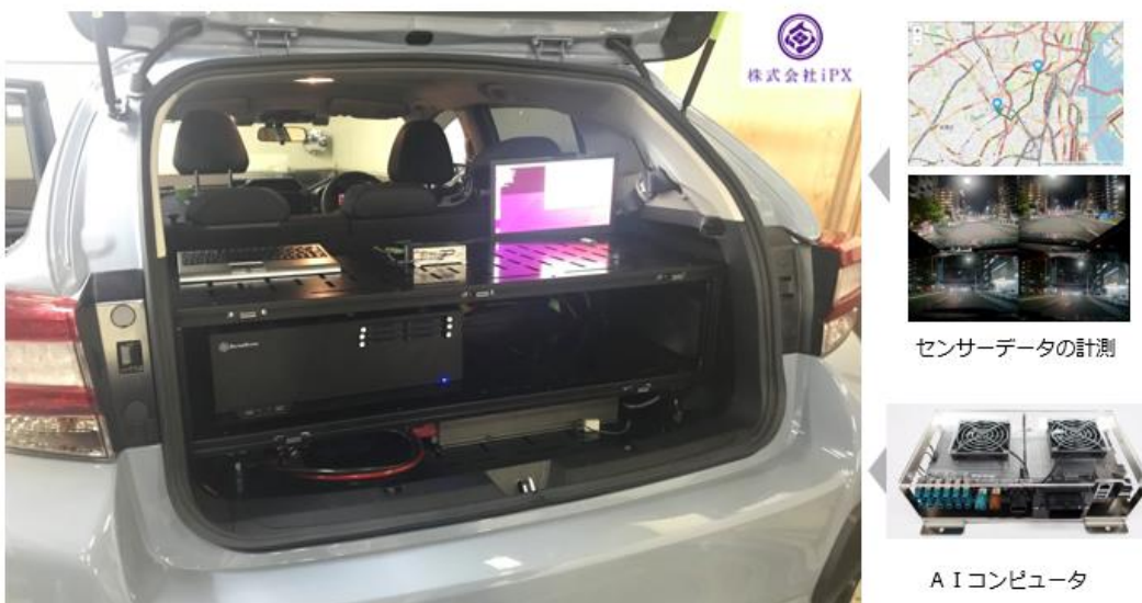
導入した計測システム(運転操作・車速・車両挙動・GPS 測位)
