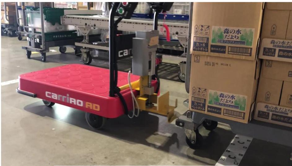
自動離脱機によるスリムカートの切り離しの様子
