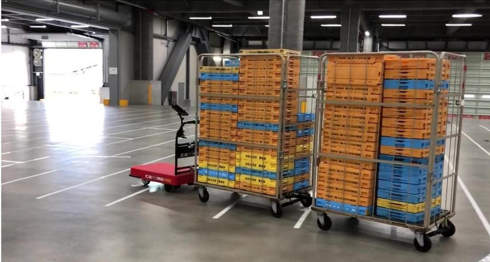
CarriRo<sup>®</sup> AD でカゴ台車を 2 台連結して搬送している様子
