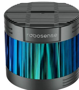
128 レイヤー 3D-LiDAR RS-Ruby
