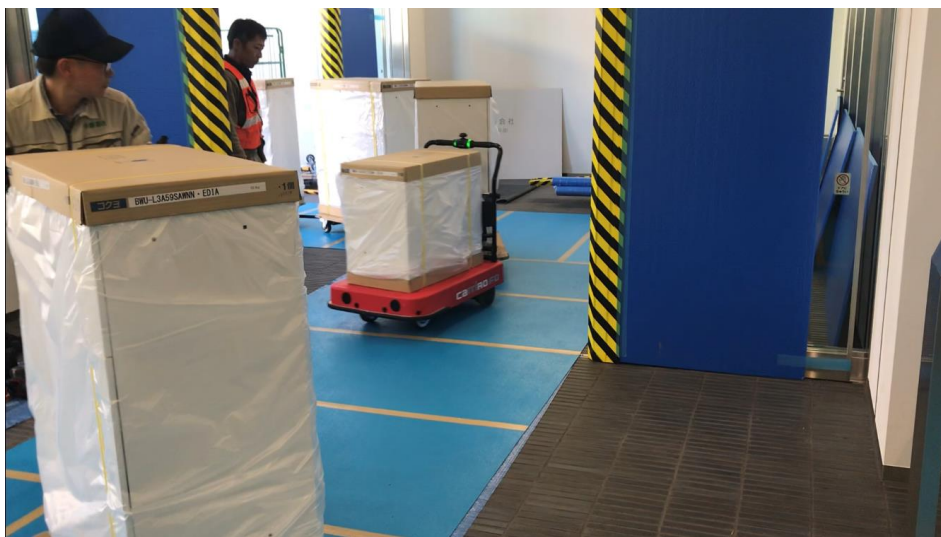
CarriRo® FD(追従モデル)に平台車を牽引させオフィス家具を搬送している様子
